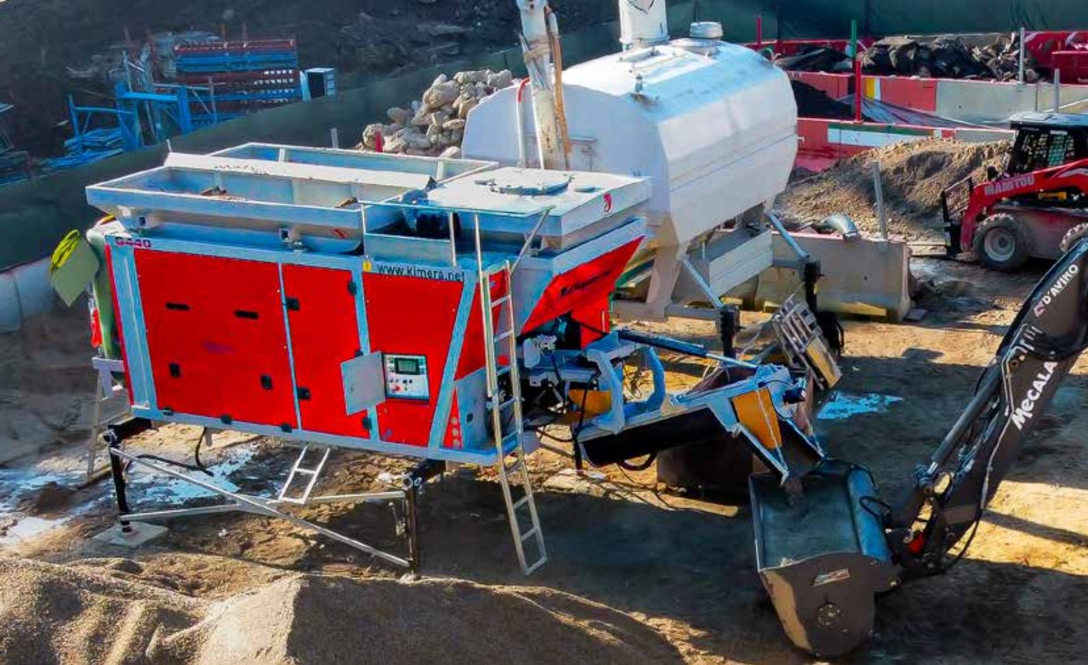
La Serie G di Kimera integra soluzioni tecnologiche avanzate per ottimizzare l'uso delle risorse e ridurre l'impatto ambientale nel settore delle costruzioni. Il sistema di miscelazione continua e il dosaggio gravimetrico garantiscono un utilizzo preciso di acqua, cemento e aggregati, minimizzando sprechi e sovrapproduzione.
